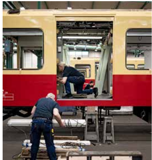
Die Deckenelektronik und die Leuchtmittel sind grundlegender Bestandteil der Modernisierung.
